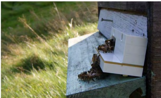
Bild 3 Teknik för att avläsa in- och utflygningar från kupan.
